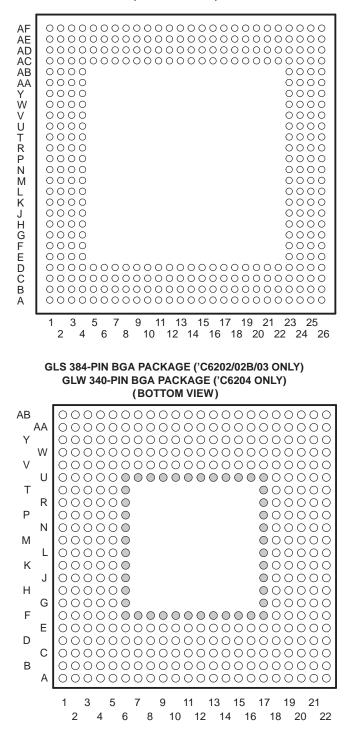
GJL 352-PIN BALL GRID ARRAY (BGA) PACKAGE ('C6202/02B/03 ONLY) (BOTTOM VIEW)
